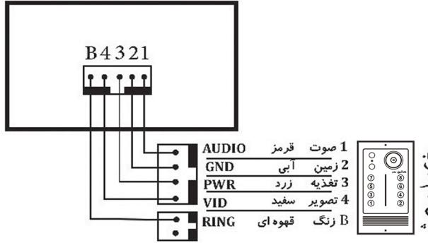
توجه : در سیم کشی **۴** سیم به بایستی سیم قرمز(صوت) به سیم قهوه ای(زنگ) متصل شود.
