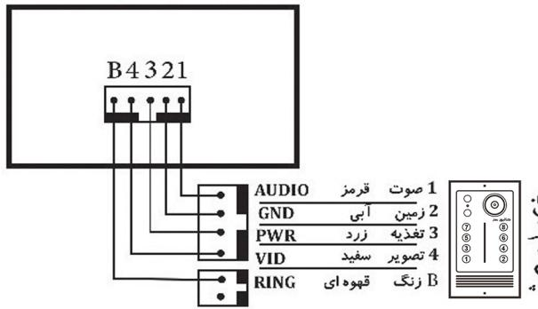
**توجه:** در سیم کشی ۴ سیمه با یستی سیم قرمز(صوت) به سیم قوهه ای(زنگ) متصل شود.
